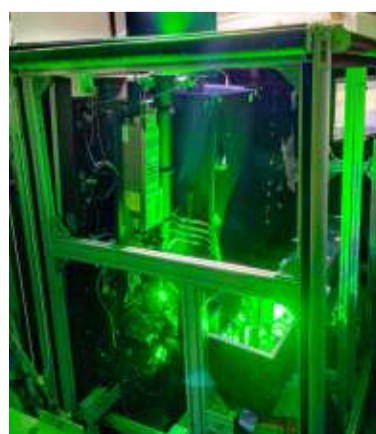
Im Container: Mit einem Laser-Lichtdard wird die Atmosphäre beobachtet.
